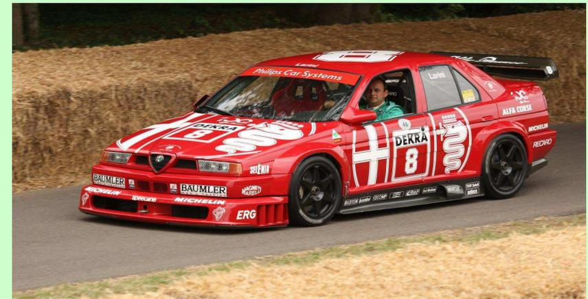
Der Alfa Romeo 155 V4 TI ist mit seinem Allradantrieb, sowie mit seinem kraftvollen 2,5-Liter-Turbo-Sechszylinder nicht zu unterschätzen.
